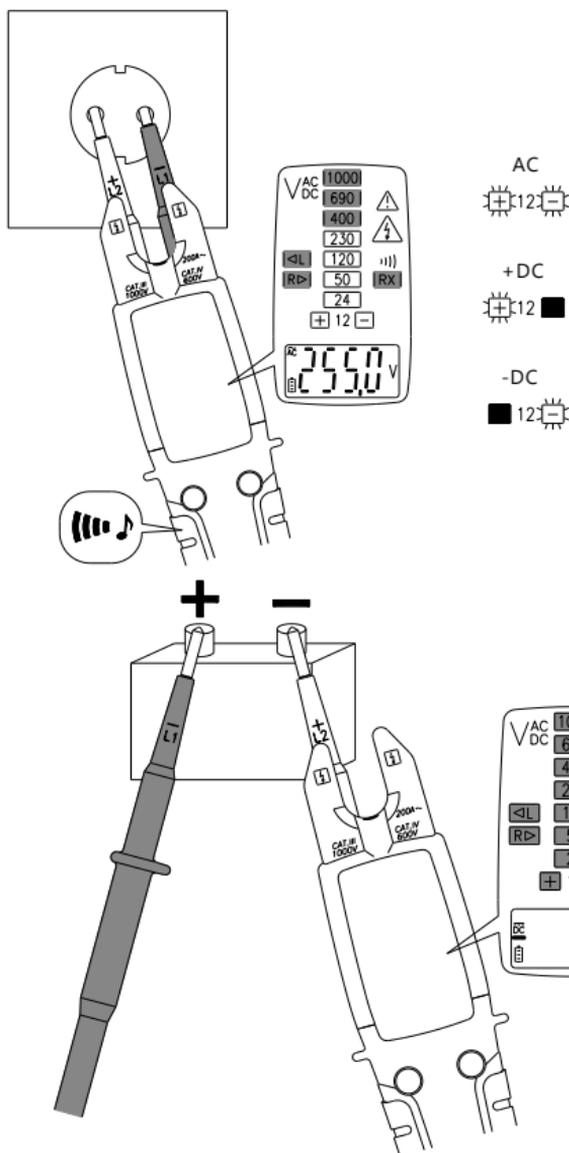
La LED indique que la tension mesurée est supérieure à la limite de tension dangereuse (50VAC et / ou 120VDC).
